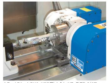
▲テールストック(P115、117参照) と合わせて、長尺物の加工 Combine with tailstock on P115, 117 to suit machining of long work pieces.
