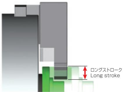
●固定ジョーのみ交換すれば段取交換、
