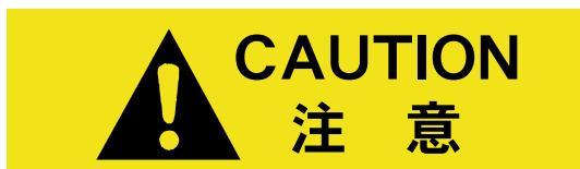
もし回避されなければ、軽傷または中程度の傷害が発生するかもしれない潜在的な危険状態を示す。
